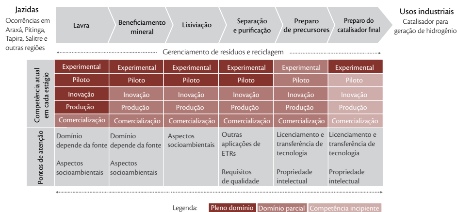
Figura 56. Competência atual em cada estágio da cadeia produtiva de catalisadores para geração de hidrogênio
