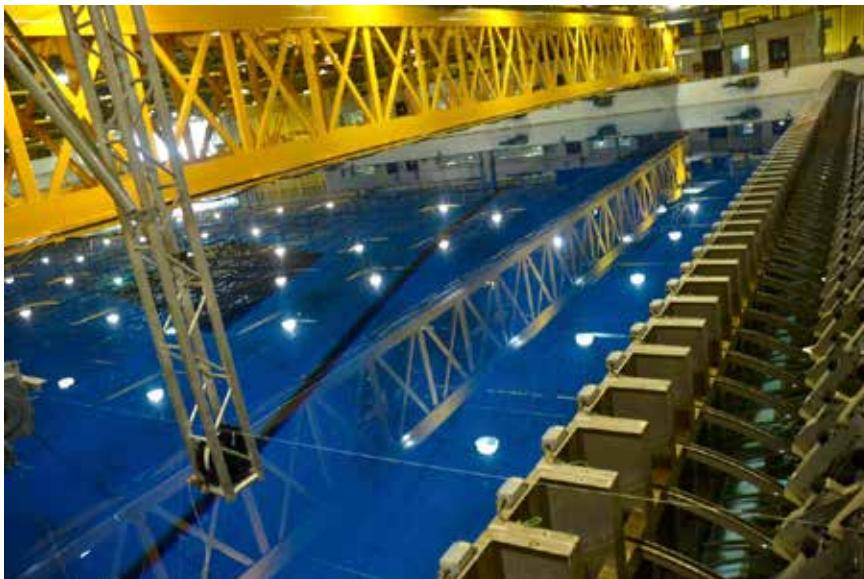
Figura 1: Gerador de ondas do LabOceano da COPPE/UFRJ
