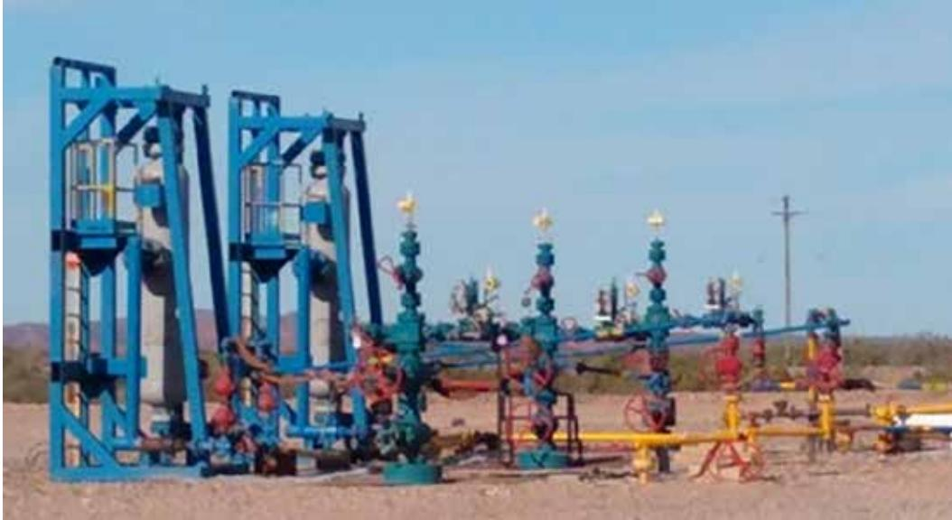
Figura 4: Poço de *shale gas* em Neuquén (Argentina)
