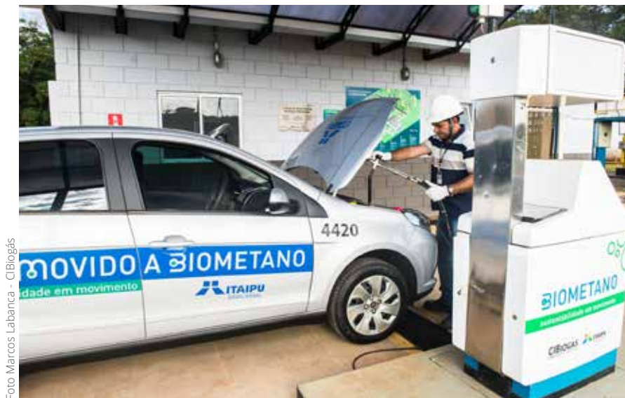
Figura 3: Abastecimento a biometano - Unidade Demonstrativa CIBiogás
